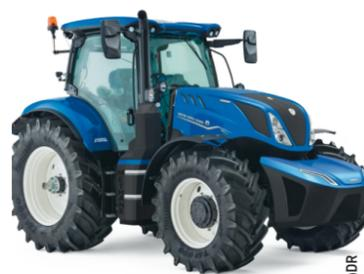
Le T6.180 Methane Power est le seul tracteur agricole sur le marché fonctionnant à 100 % au biométhane. Un carburant qui favorise l'autonomie énergétique des exploitations et présente un bilan carbone amélioré voire négatif quand il provient de lisiers. Les performances sont annoncées identiques à celles d'un tracteur diesel.
