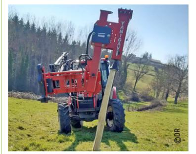
Le MPEV 600 CT est un enfonceur pieux pouvant s'installer sur de nombreux porteurs : tracteurs, télescopiques, chargeuses, pelles... Son fonctionnement garantit l'absence de vibrations dans le bras du porteur. Une pince évite à l'utilisateur de descendre pour mettre en place le piquet.
