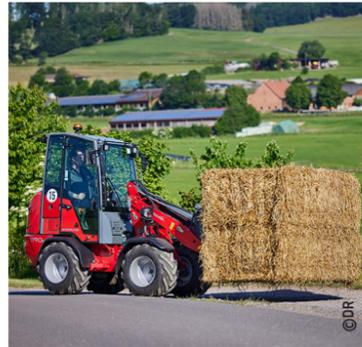
La chargeuse compacte sur pneus 1190E dispose d'un entraînement entièrement électrique avec cabine (concept unique de chauffage et de ventilation) et trois batteries Li-ion différentes au choix. Ce modèle dispose des mêmes fonctions que son homologue diesel.
