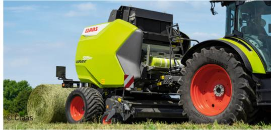
Claas apporte aussi des évolutions au système de liage. L'emplacement du filet a été abaissé de 30 cm, facilitant son chargement. Le nouveau frein garantit une tension constante, quel que soit le diamètre du rouleau. Notons l'évolution de la tôle d'introduction et du système de déclenchement des couteaux amé-
