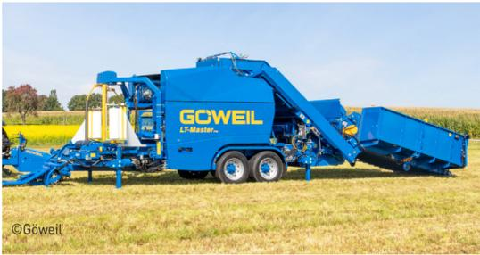
sormais un tambour de dosage, qui régularise le flux de produit et facilite le pressage des matériaux fibreux, tels que la luzerne et le chanvre. Confectionnant des balles de 0,60 à 1,15 m de diamètre,
