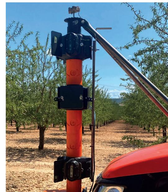
Chez Kubota, ce système permet de mesurer les variations de volume foliaire et donc de moduler automatiquement la dose de produit de traitement.
