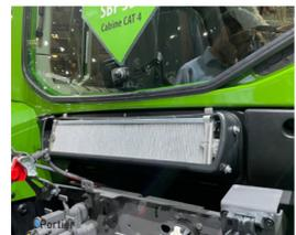
Le système s'intègre dans l'emplacement dédié au filtre d'habitacle sous le hayon de la cabine. Le filtre standard est remplacé par deux filtres, le premier retenant la poussière et le second à charbon actif captant les vapeurs toxiques. Ces deux filtres s'accompagnent d'un petit ventilateur assurant la suppression de la cabine.
