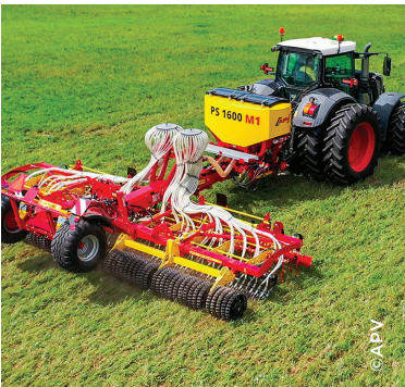
d'un lit de semence. Elles sont suivies de patins semeurs qui incorporent les graines. Ensuite, le rouleau referme le sillon et améliore la germination avec un bon contact semence-terre et une bonne capillarité. ■
