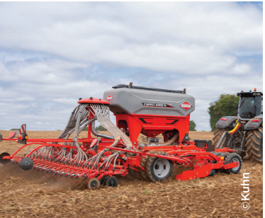
individuellement et indépendamment. La pression maximale de terrage passe de 80 kg sur la gamme Espro 1000 (R) à 120 kg sur les variantes 1002 (R). ■
