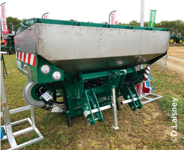
trémie unique. Le pilotage indépendant des trois doseurs est simplifié par la technologie Isobus permettant de tout gérer depuis un seul écran. ■
