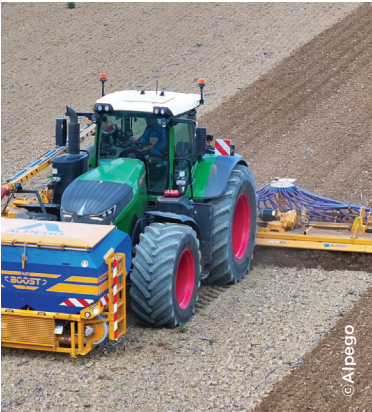
Alpego TC7 ou celui du tracteur. Pour le transport des produits vers la barre de semis arrière, il est possible d'opter pour un seul ou deux tuyaux latéraux, selon le choix de l'utilisateur de déposer ou non les semences et l'engrais à des endroits différents. ■
