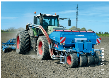
est réalisé à l'aide d'une manivelle centralisée. La pression sur la rampe de semis est mécanique ou hydraulique, atteignant respectivement jusqu'à 45 kg ou 70 kg par élément. Avec la déclinaison à double trémie du Solitaire MR, Lemken offre le choix entre un mélange des deux produits dans la même conduite (single shot) ou dans deux circuits différents (double shot). Le semoir Solitaire MR est piloté en standard par un terminal Isobus, dont le nouveau petit terminal CCI 60 (qui ne propose pas la coupure de demi-largeur). ■
