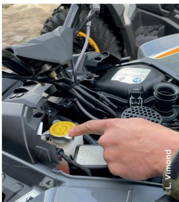
▲ De temps en temps, vérifier le niveau de liquide de refroidissement.
