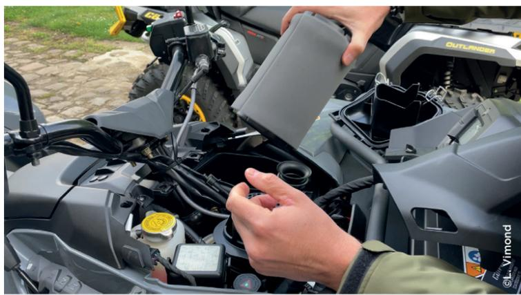
▲ Si le quad travaille en milieu poussiéreux, il convient de vérifier fréquemment le filtre à air.
