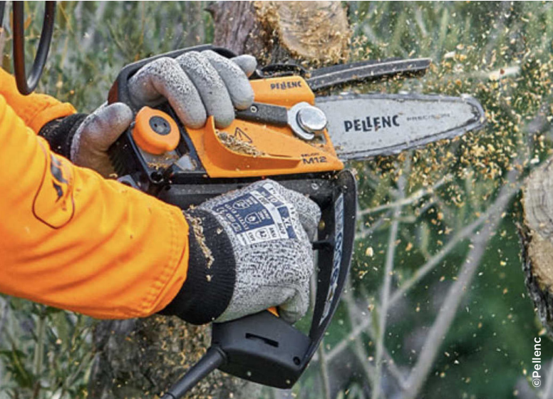
▲ La cureteuse Pellenc dispose d'une batterie dorsale. Sa chaîne est large, facilitant l'affûtage.
