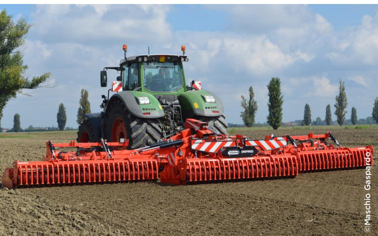
les composants mécaniques et électriques des modèles Toro Super Isotronic et Jumbo Super. La transmission de la puissance vers les lamiers latéraux est assurée par des cardans spéciaux à triple extension et quatre boîtes de vitesses avec refroidissement. Au transport, le
