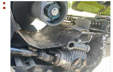
Sur le cueilleur Rovio repliable, la puissance est transmise aux rangs extérieurs par un mécanisme à crabot. Les noix d'accouplement peuvent s'arrondir à force de crabotages brutaux. Pour les préserver, Olivier Jardin préconise, après le dépliage, de démarrer d'abord le cueilleur en marche arrière en activant le système d'inversion hydraulique. Ainsi, le crabotage s'effectue en douceur et préserve les pièces s'engrenant entre elles.
